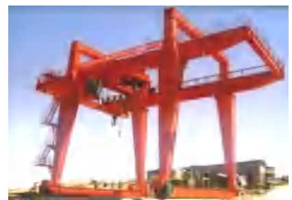
超大起升高度（400 米）门机
